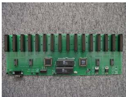
Obr. 2 – Základní deska vlastní konstrukce Automatizovaného systému správy síťových konfigurací
